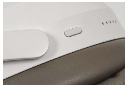
Klasyczny przycisk jest tylko jeden i służy przede wszystkim do włączania słuchawek, ponadto aktywuje tryb parowania BT.
