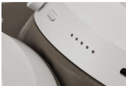
Ukryte wewnątrz mikrofony podsłuchują hałasy i nasze rozmowy przez szereg otworków.
